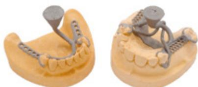
Un revêtement de précision fin, à liant phosphate et sans graphite. Micro peut être utilisé comme revêtement CrCo et est également utilisé avec succès dans la technique des couronnes et des bridges. Comme pour MORSIT, l'expansion est régulée par l'utilisation de liquides de type 100 ou 140.
