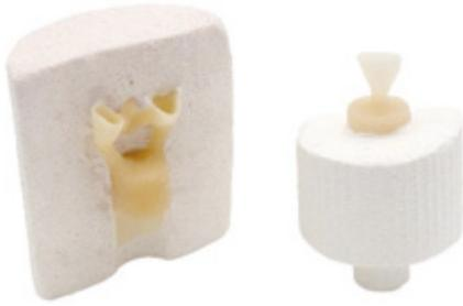
Revêtement de précision à liant phosphate BA, sans graphite, spécialement conçu pour tous les systèmes céramiques pressables dans la technique de coulée rapide. Silavest Press peut être utilisé pour les systèmes de pressage du métal et de pressage du zirconium. Ce revêtement super fin garantit un ajustement parfait et une surface très lisse.
